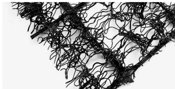
Рисунок 2 - Трехмерная структура геомата
