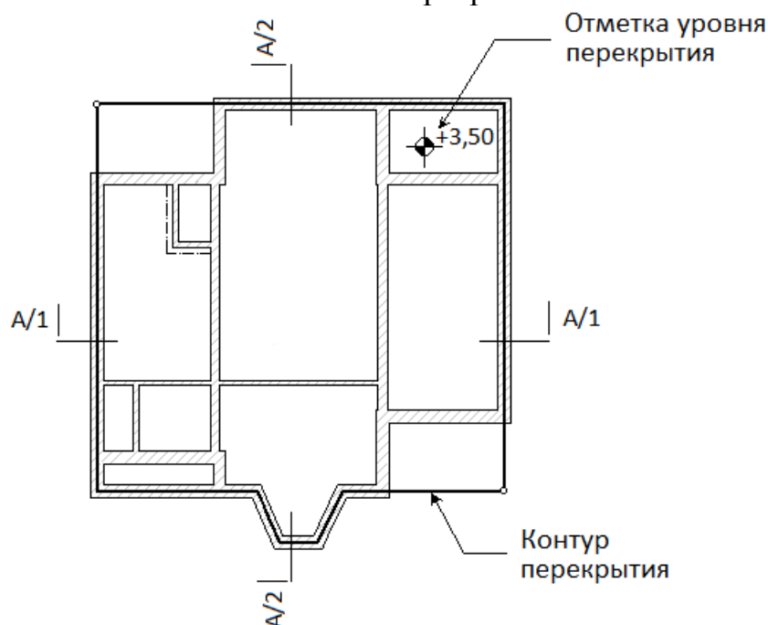
Рисунок 38 - План монолитного перекрытия
