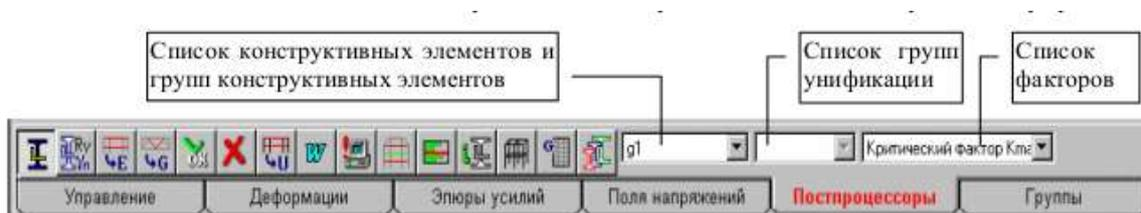
Рис. 5.13. Инструментальная панель постпроцессора проверки несущей способности стальных сечений
