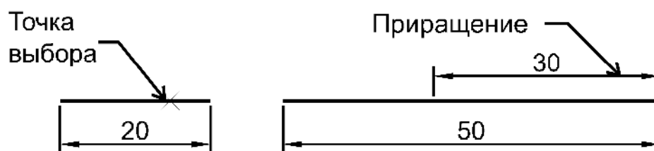
Рис. 8.7. Удлинение отрезка на DELta=30.
