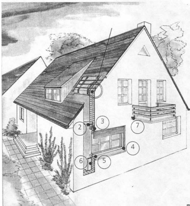
Рис.8.6. Потери энергии в деталях строений (критические зоны)
