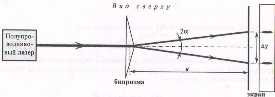
Рис. 6. Схема опыта по прохождению лазерного луча через бипризму Френеля
