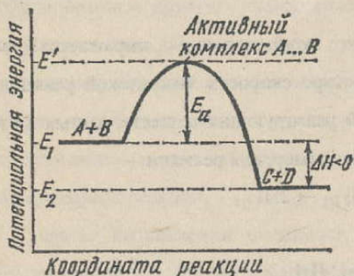
Рис.1. Энергетическая диаграмма экзотермической реакции
