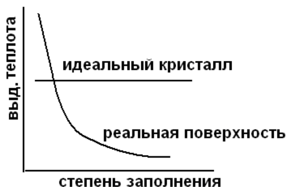
Рис.4.5. Изменение дифференциальной теплоты адсорбции от степени заполнения в зависимости от характера поверхности.
