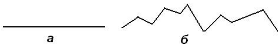
Рис.4.4. Профиль идеально гладкой (а) и реальной поверхности (б).
