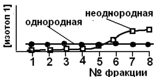
Рис. 4.6. Изменение изотопного состава фракций десорбированного адсорбата в зависимости от характера поверхности.
