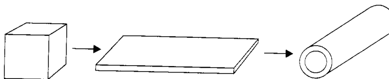
Рис. 7.2. Изменение площади поверхности образца при «прокате».
