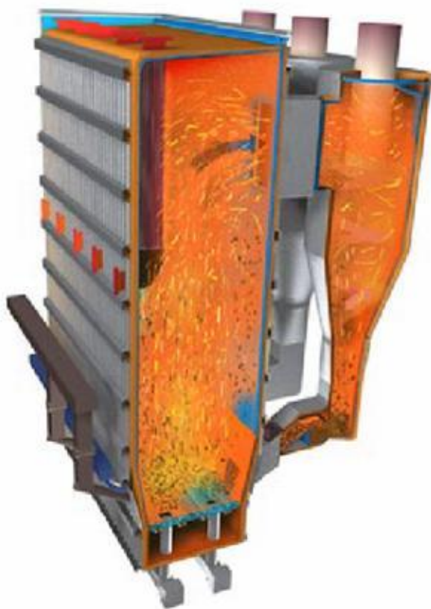
Рис. 24. Топка котла с циркулирующим кипящим слоем
