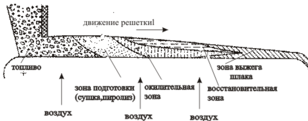
Рис. 20. Схема зажигания слоя на цепной решетке
