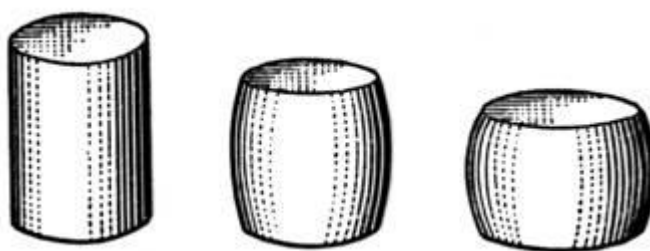
Рис. 2.1. Деформация стального образца при сжатии
