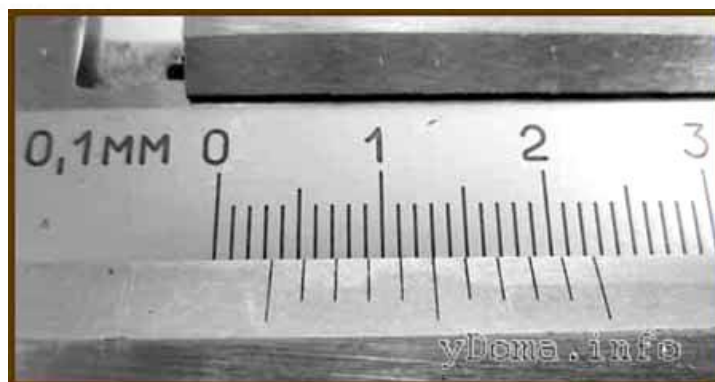
Рисунок 4 – Шкала штанги и нониус
