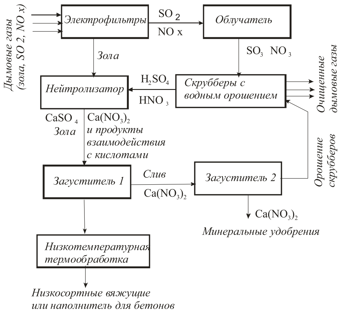
Рис. 2.37. Схема радиационно-химического обезвреживания дымовых газов («мокрый способ»)
