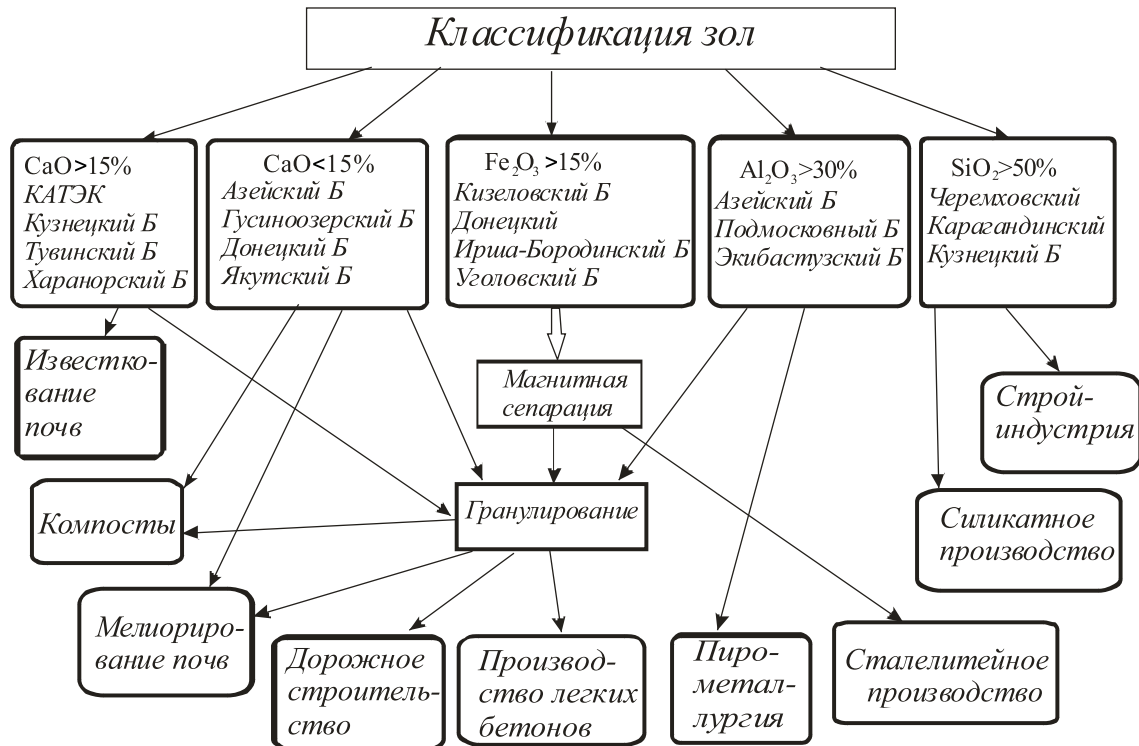
Рис. 2.38. Схема утилизации зол согласно классификации состава
