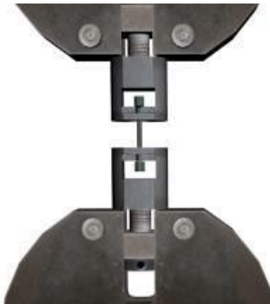
Рисунок 3.2. Зажатый между кулачками образец
