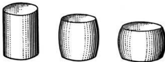
Рисунок 1.1. Деформация стального образца при сжатии
