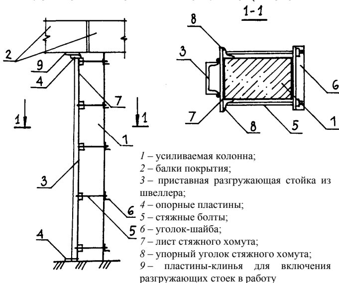
УСТАНОВКА ПРИСТАВНЫХ РАЗГРУЖАЮЩИХ СТОЕК
