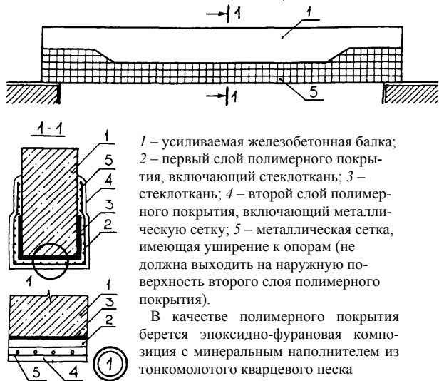
НАКЛЕЙКА НА РАСТЯНУТОЙ ЗОНЕ СТЕКЛОТКАНИ И МЕТАЛЛИЧЕСКОЙ СЕТКИ (А. с. № 850850)
