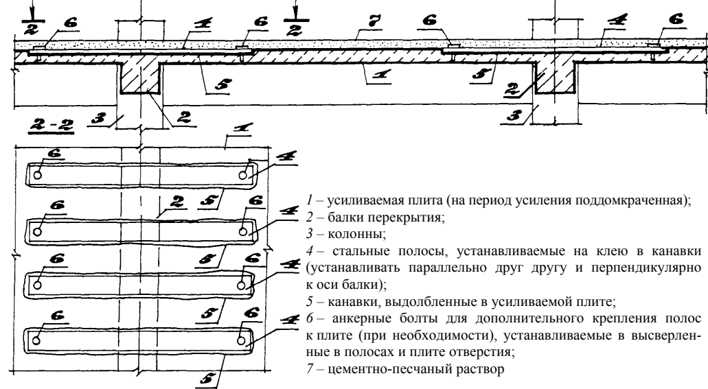
ЗАКРЕПЛЕНИЕ СВЕРХУ МЕТАЛЛИЧЕСКИХ ПОЛОС (ПАТЕНТ ЯПОНИИ № 52-42960)
