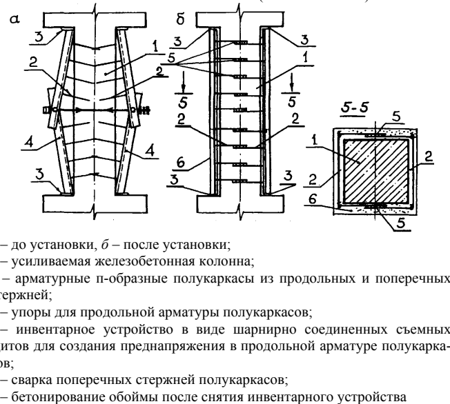
УСТАНОВКА ПРЕДВАРИТЕЛЬНО НАПРЯЖЕННОГО АРМАТУРНОГО КАРКАСА (А. с. № 1189975)
