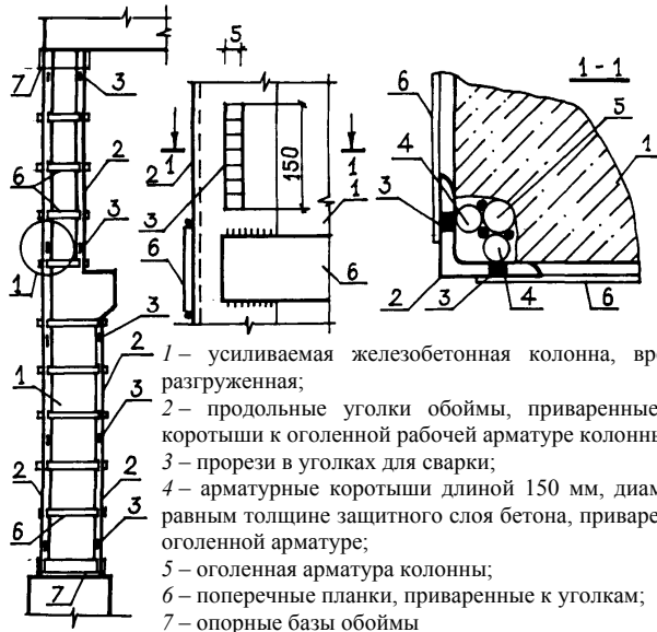
УСТРОЙСТВО ПРЕДВАРИТЕЛЬНО НАПРЯЖЕННОЙ МЕТАЛЛИЧЕСКОЙ ОБОЙМЫ (А. с. № 1470910)
