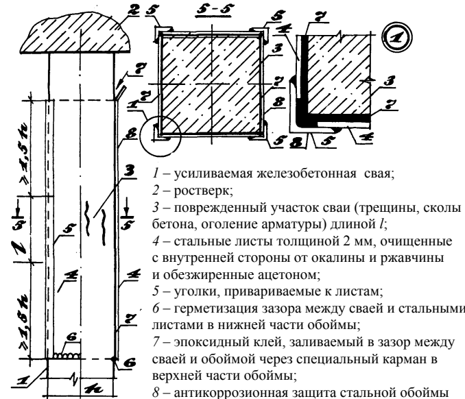
УСТРОЙСТВО СТАЛЬНОЙ ОБОЙМЫ
