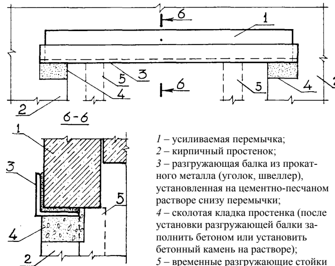
ПОДВЕДЕНИЕ РАЗГРУЖАЮЩИХ БАЛОК ИЗ ПРОКАТНОГО МЕТАЛЛА
