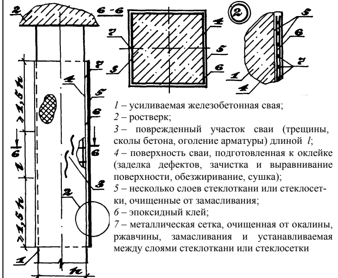
УСТРОЙСТВО ОБОЙМЫ ИЗ АРМИРОВАННОГО СТЕКЛОПЛАСТИКА
