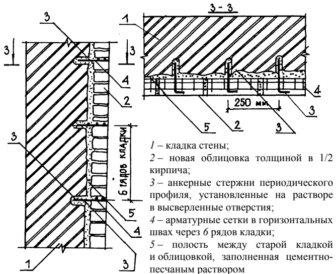
ВОССТАНОВЛЕНИЕ РАЗРУШЕННЫХ НАРУЖНЫХ УЧАСТКОВ СТЕН УСТРОЙСТВОМ ОБЛИЦОВОК С УСТАНОВКОЙ СТАЛЬНЫХ СВЯЗЕЙ
